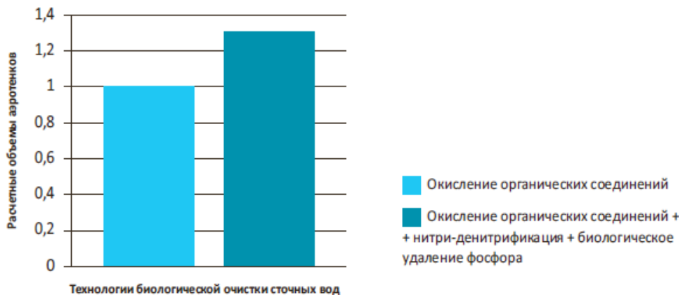
Рис. 2. Соотношение расчетных объемов аэротенков при реализации различных технологий биологической очистки сточных вод к проектному объему аэротенков при фактическом расходе поступающих сточных вод
