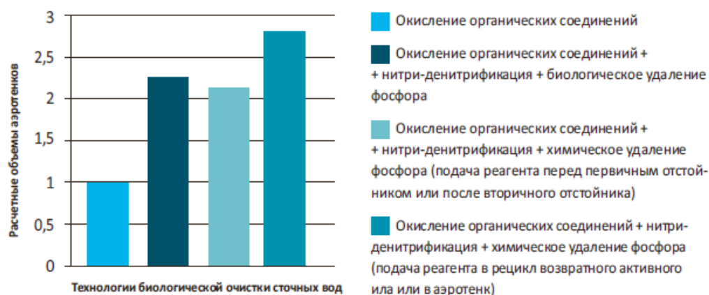
Рис. 1. Соотношение расчетных объемов аэротенков при реализации различных технологий биологической очистки сточных вод к проектному объему аэротенков при проектном расходе поступающих сточных вод
